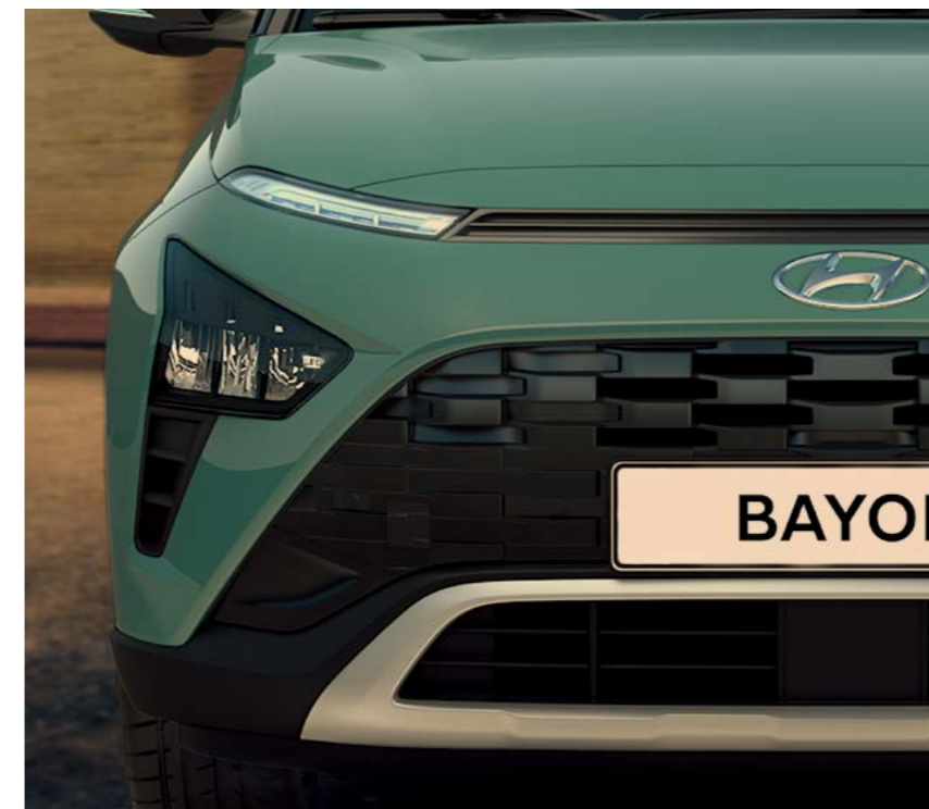
הפנסים הקדמיים מחולקים לשלושה חלקים ופועלים בטכנולוגיית LED* ופנסי האיתות נפרדים מתאורת היום. כל אלה תורמים להשגת המראה הייחודי.
