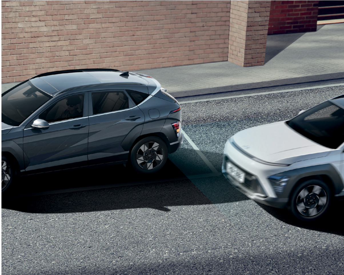
מערכת אקטיבית לזיהוי ומניעת התנגשות בכלי רכב ב"שטח מת" (BCA)* מערכת מבוססת רדאר המתריעה על רכבים ב"שטח מת" בעת מעבר נתיב ומבצעת תיקון הגה אוטומטי במידה והנתיב אינו פנוי.
