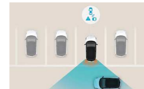
התרעה ומניעת פגיעה ברכב חוצה מאחור (RCCA)* מערכת אקטיבית להתרעה ומניעת פגיעה ברכב חוצה בעת נסיעה לאחור.
