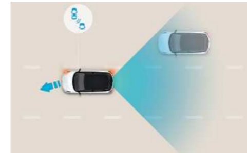
מערכת אקטיבית לזיהוי רכב ב"שטח מת" (BCA)* מערכת אקטיבית המתריעה על רכב ב"שטח מת" למניעת התנגשות בעת מעבר נתיב.
