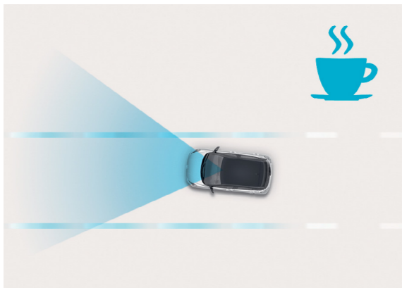
מערכת התרעה על ערנות נהג (DAW) התרעה קולית ומסר כתוב המציע הפסקת ריענון להגברת הבטיחות במצבים של עייפות או חוסר ריכוז.
