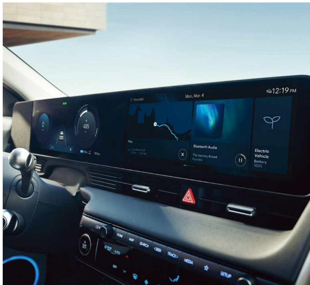
צג רחב המשלב מערכת מולטימדיה ולוח מחוונים בגודל 12.3"
