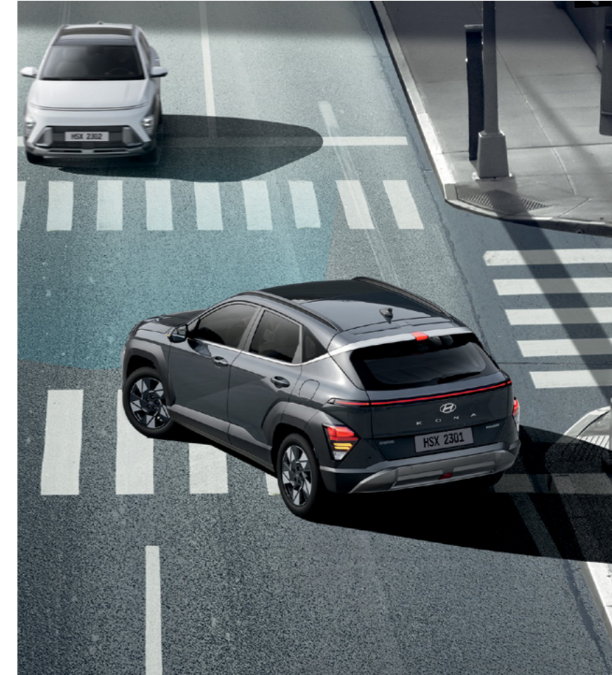
בלימה אוטונומית במצבי חירום (FCA-JT) מערכת אקטיבית המתריעה מפני סכנת התנגשות. במידה וסכנת ההתנגשות עולה לאחור ההתרעה, המערכת תבצע בלימת חירום אוטומטית. המערכת כוללת זיהוי כלי רכב, דו גלגלי ותנועה חוצה בצומת מכל הכיוונים.
