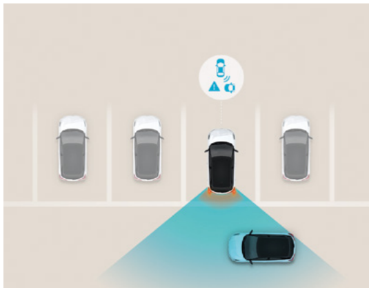
מערכת למניעת פגיעה ברכב חוצה בעת נסיעה לאחור (RCCA) מערכת המתריעה מפני רכב החוצה את מסלול הנסיעה לאחור.
