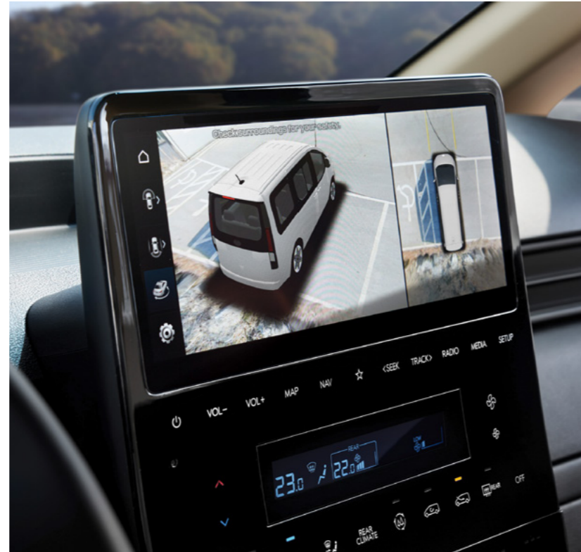
מערך מצלמות היקפיות (SVM)* יונדאי סטאריה ההיברידיה מצוידת במערך 4 מצלמות היקפיות.
