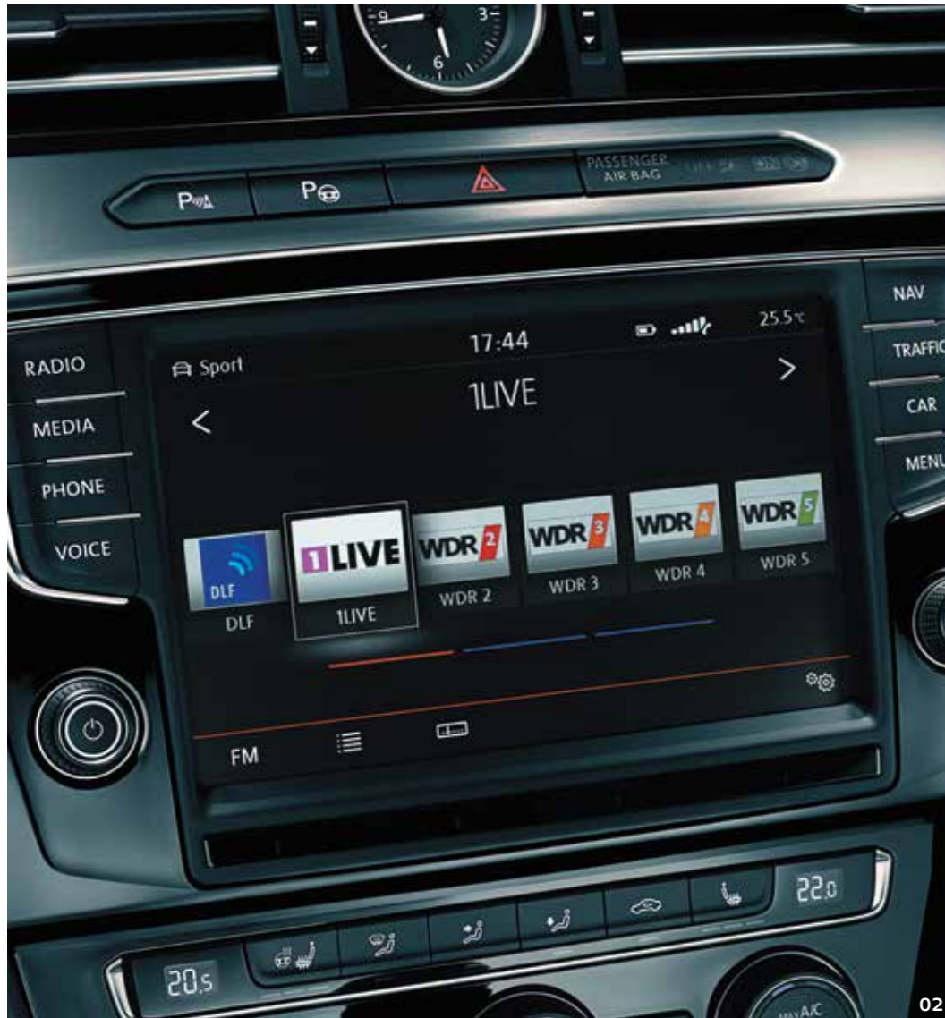
02 מערכת שמע Discover pro בעלת צג צבעוני בגודל 8 אינץ' עם Voice control ומערכת Active info display * כחלק מחבילת Interactive
